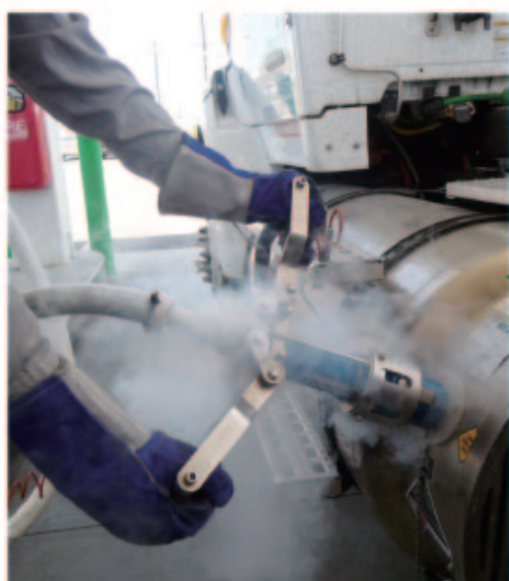
6) “破冰”技术使加注完毕后加液枪可以迅速脱离加注口
