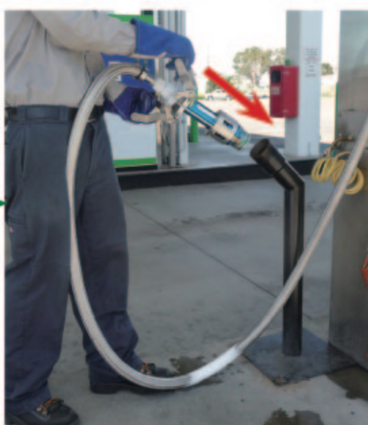
8) 将LNG加液枪对接在支架上放置
