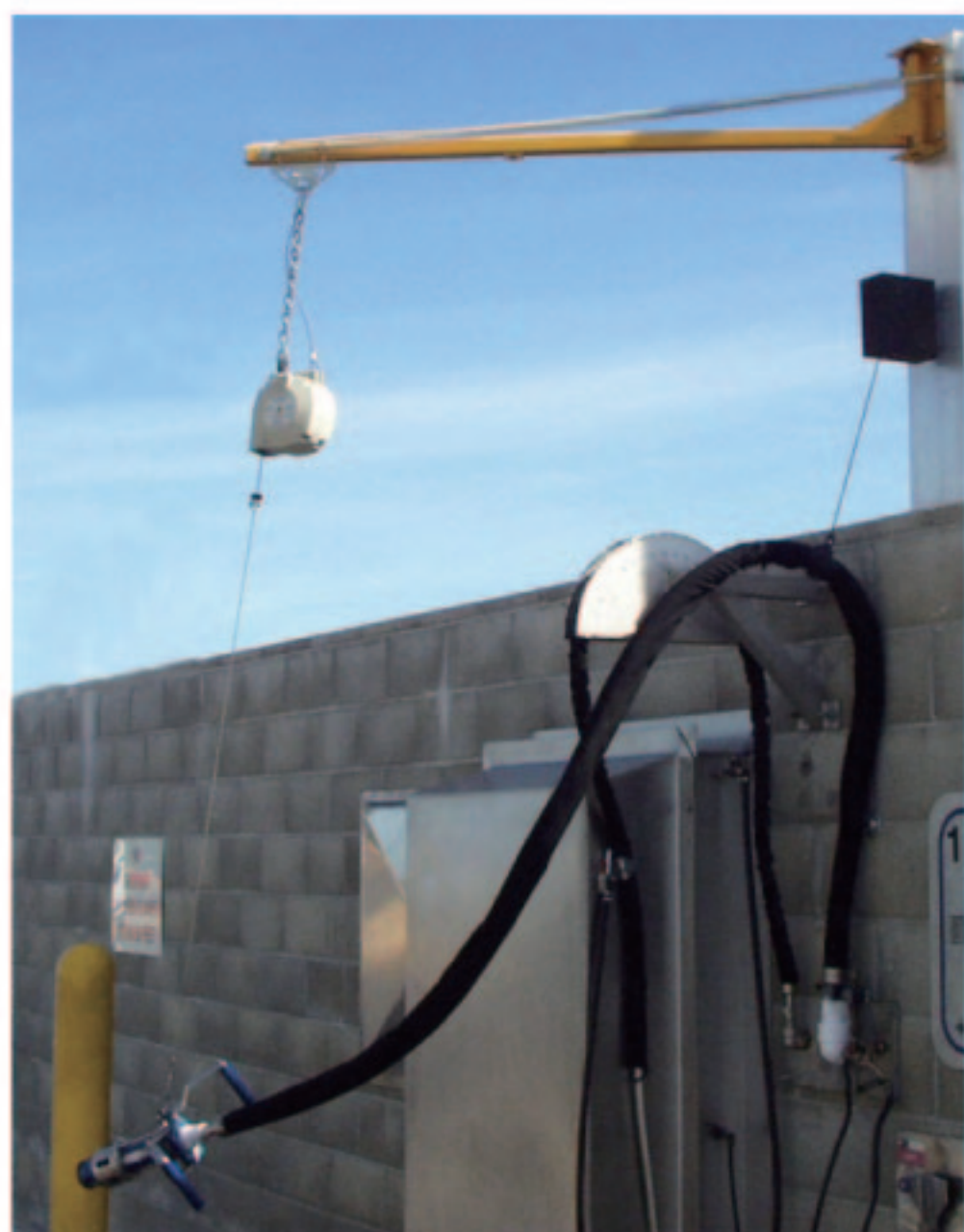
型号 6704A64 加液枪可旋转平衡挂钩
