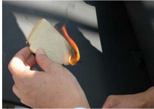
传统的PIR材料氧指数偏低，而且要应用大量防潮层，粘接剂等燃烧级别较低的辅材。
